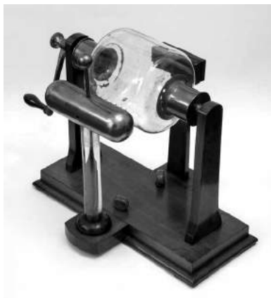
Fot. 5. Maszyna elektrostatyczna cylindryczna wg. Nairne'a, w konstrukcji zbliżona do znajdującej się w gabinecie fizycznym szkoły dominikanów, k. XVIII w., własność Muzeum Uniwersytetu Jagiellońskiego, fot. Janusz Kozina
